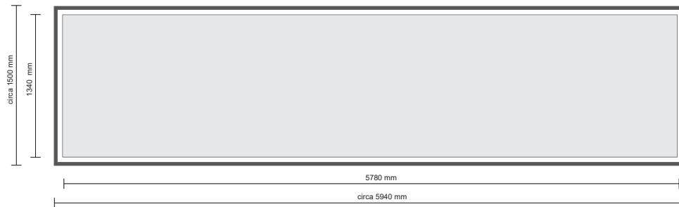
BUITENZIJD | vooraanzicht en achteraanzicht (boven) Signing spandoeken in buizenframe (montage met elastieken) op aanvraag doekmaat: 5780x1340mm
